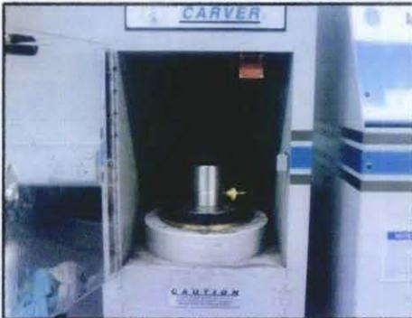
**Figure 5 :** Autopallet press machine
