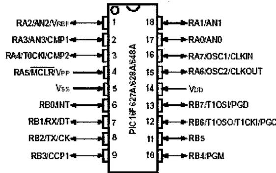
Figure 2: PIC16F628A Pin Diagram
