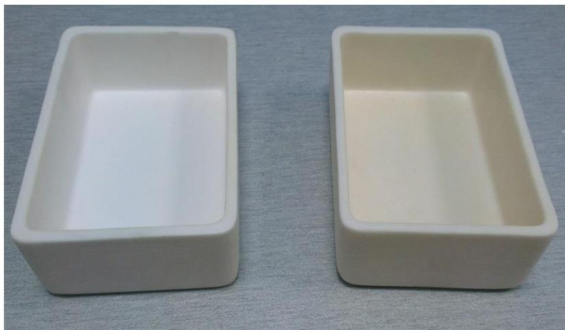
**Figure 6. Alumina crucibles**
