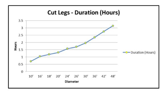
FIGURE 9 DECK LEG CUTTING DURATION (TSB OFFSHORE, INC.)
