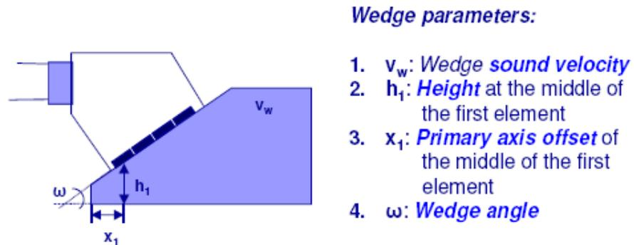
**Fig 2.17: Wedge parameters**
