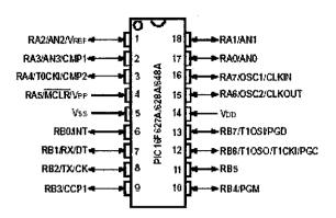
Figure 2: PIC16F628A Pin Diagram
