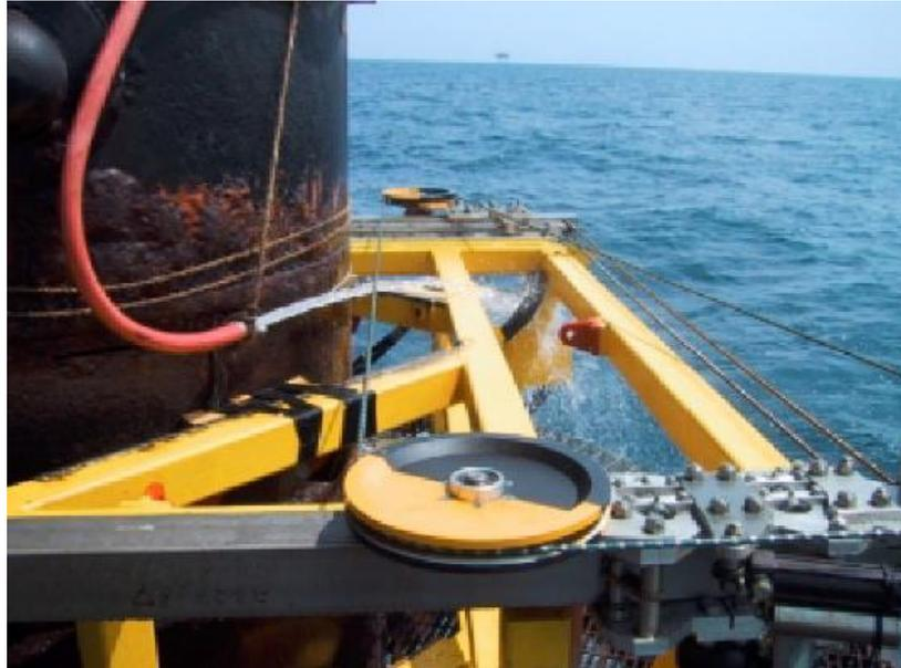
FIGURE 4 DIAMOND WIRE SYSTEM (SNYDER & BYRD, 2004)
