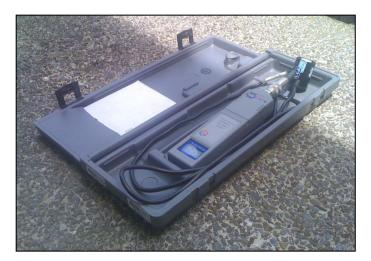
Figure 3.9 : Solarimeter
