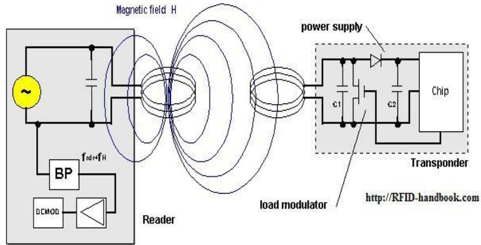
**Figure 1 : Load Modulation Circuitry**
