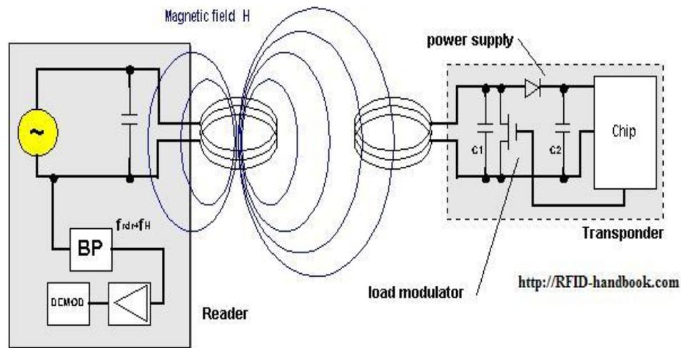
**Figure 1 : Load Modulation Circuitry**
